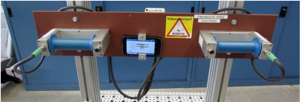
Abbildung 7-3: Kraftmessgriffe, Datenlogger und Smartphone [fml-16c]
