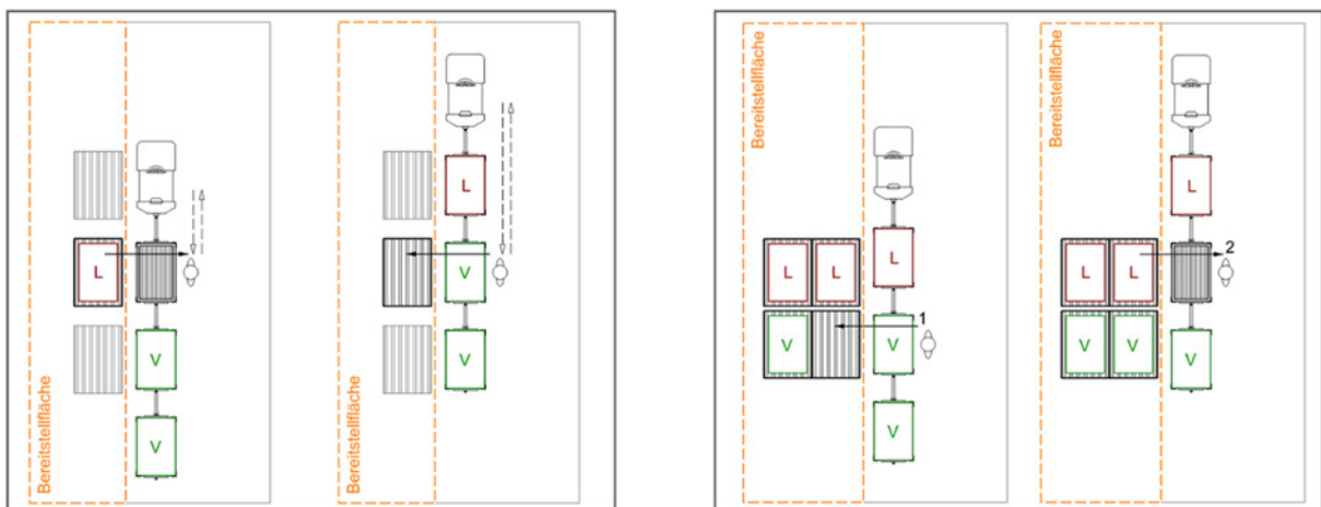
Abbildung 6-12: Bereitstellung von GLT an I-Gebinde (links) und U-Gebinde (rechts) [fml-16d]
